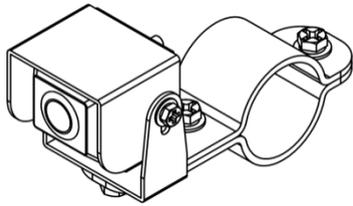
本機は車外防水カメラTA-Y701B04・TA-Y750A02専用のカメラ取付金具です。
